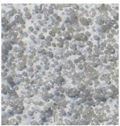
FIGURE 3-8. EXCELLENT BEAD DISTRIBUTION OF TYPE III BEADS.
