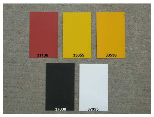
FIGURE 7-11. FEDERAL STANDARD 595B COLORS FOR AIRFIELD MARKINGS
