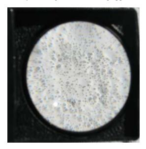
FIGURE 3-4. POOR TYPE I BEAD DISTRIBUTION; READINGS AVERAGED ONLY 135 mcd/m<sup>2</sup>/lux.
