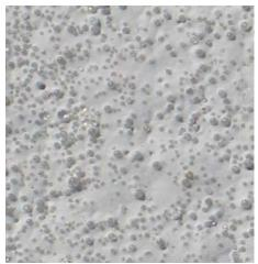
FIGURE 3-7. POOR BEAD DISTRIBUTION OF TYPE III BEADS.
