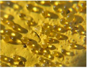
FIGURE 3-11. POOR TYPE IV BEAD EMBEDMENT.
