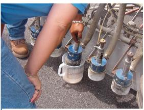
FIGURE 6-60. CALIBRATION OF GLASS BEAD GUNS.
